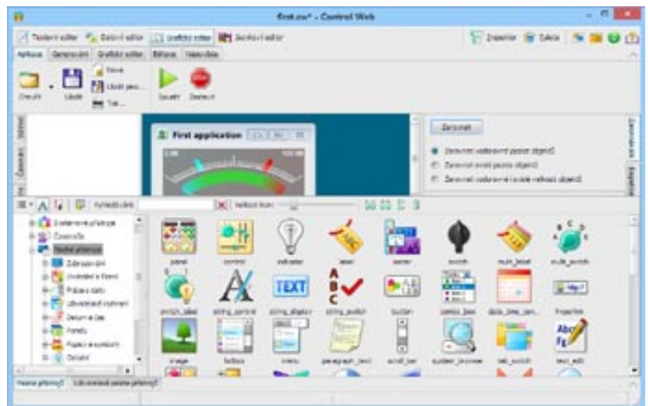
Vysunutý nástroj Paleta přístrojů nabídne třídy virtuálních přístrojů. Jakmile uživatel vybere přístroj a začne jej přesouvat do aplikace, paleta se opět svine a uvolní místo samotné aplikaci.
